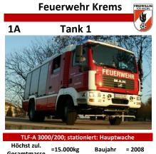
Gesamtmasse Leistung (PS) = 280PS Besatzung = 1:7 Achsen = 2 Reifen Wassertank = 3.0001Schaumtank = 2001 Aufbau: Rosenbauer
