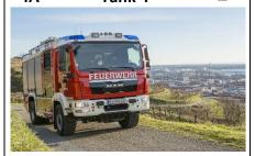
Höchst zul. =15.500kg = 2015 Baujahr Gesamtmasse Leistung (PS) = 290PS Besatzung = 1:7 Reifen Achsen Wassertank = 2.000l Schaumtank = nein Aufbau: Rosenbauer
