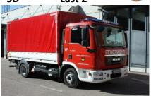
Höchst zul. = 8.800kg Baujahr = 2013 Gesamtmasse Leistung (PS) = 180PS Besatzung = 1:2 Reifen Achsen Wassertank Schaumtank = nein = nein
