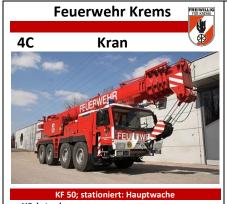
Höchst zul. =48.000kg Baujahr = 1998 Gesamtmasse Leistung (PS) = 408PS Besatzung = 1:1 = 8 Achsen = 4 Reifen Wassertank = nein Schaumtank = nein Aufbau Liebherr
