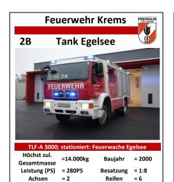
Tank Egelsee rückt zu Brandeinsätzen sowie auch zu technischen Einsätzen aus. Er verfügt über eine Wärmebildkamera, ein Gasmessgerät und einen 60m langen Schnellangriffsschlauch und einen 3.000 Liter Wassertank.
