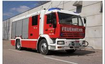
Höchst zul. =14.000kg Baujahr = 2003 Gesamtmasse Leistung (PS) = 250PS Besatzung = 1:6 Achsen Reifen Wassertank = 2.0001Schaumtank = nein
