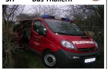
Höchst zul. = 3.500kg = 2003 Baujahr Gesamtmasse Leistung (PS) = 120PS Besatzung = 1:8 Achsen = 2 Reifen Wassertank = nein Schaumtank = nein
