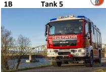
Höchst zul. =15.500kg Baujahr = 2015 Gesamtmasse Leistung (PS) = 290PS Besatzung = 1:7 Achsen Reifen Wassertank = 2.0001Schaumtank = nein Aufbau: Rosenbauer
