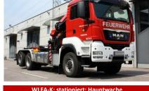
Höchst zul. =28.800kg Baujahr = 2009 Gesamtmasse Leistung (PS) = 400PS Besatzung = 1:2 Reifen Achsen Wassertank Schaumtank = nein = nein Aufbau: diverse Wechselladeaufbauter
