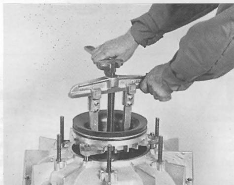
Die Laufradschraube abschrauben und die Scheibe entfernen.
