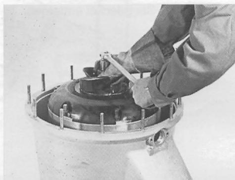
Eine Schraube 81 40 21 (M16) in die Gewindescheibe unter der Laufradschraube schrauben,
