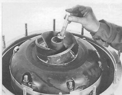
Die Schraube mit der Gewindescheibe montieren.
