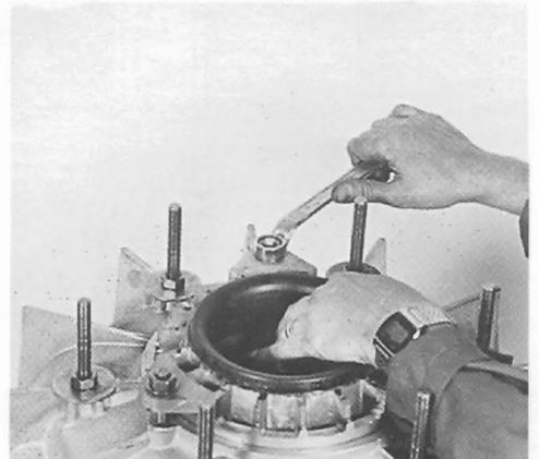
Die Pumpe umdrehen und die kompletten Federn, bestehend aus Abstandshülsen, Gummibuchsen und Spiralfedern, aufsetzen.
